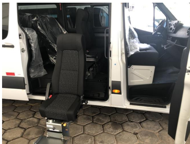
Veículo equipado com DPM (Dispositivo de Poltrona Móvel) para transporte de passageiros e acessibilidade
