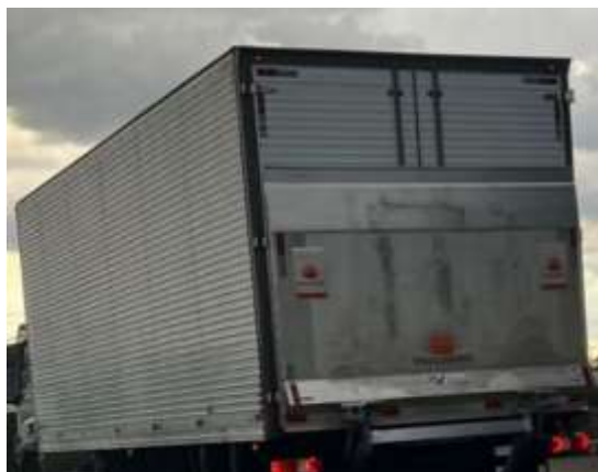
Veículo traçado com plataforma elevatória acoplada no baú
