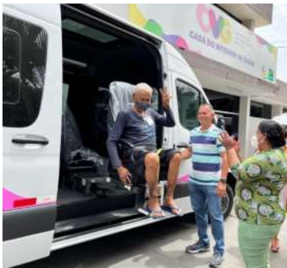
Veículo equipado com DPM (Dispositivo de Poltrona Móvel)
