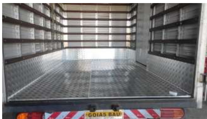
Substituição do assoalho em madeira por alumínio - baú de caminhão leve
