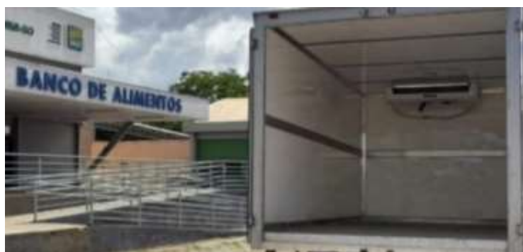
Baú transformado em carga refrigerada
