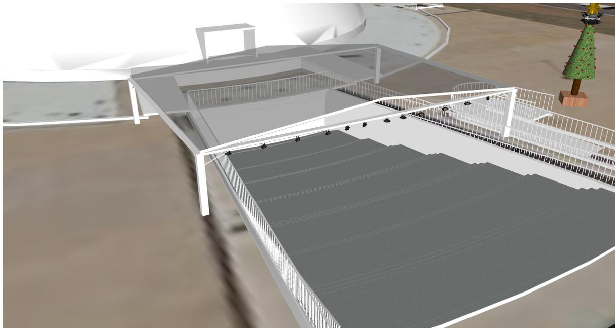
A angulação dos equipamentos devem ser inclinados de para iluminação da escada como um todo
