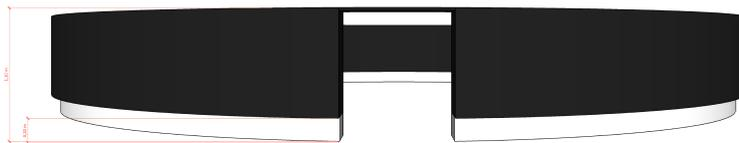
PAREDE EM COMPENSADO 4mm, REVESTIDO DE TECIDO PRETO (OXFORD)
